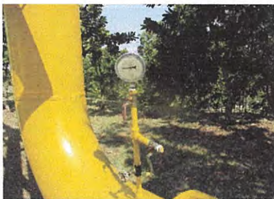
รูปการทดสอบเปรียบเทียบมาตรวัดความดัน
